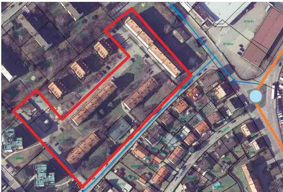
RÄUMLICHEN ZUSAMMENHÄNGE: Die rote Linie zeigt die zum Projekt gehörenden Gebäude, gelbe Linie zeigt den Verlauf des Hauptsammlers, blaue Linie die Nebenverläufe der Kanalisation, hellblaue Scheibe markiert den Standort des Entnahmeschachts. Bild 2
